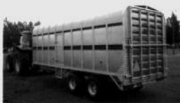
Bateson traktorhenger, leveres i en og to etg.
