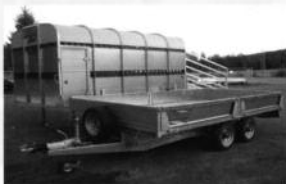
Bateson Bilhenger m/ demonterbart dyreskap i 2 etg
